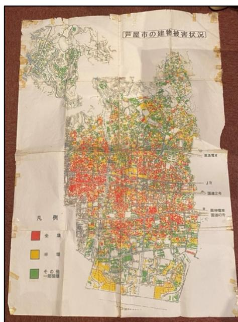
図 2.1 阪神淡路大震災芦屋市の建物被害状況図（元芦屋市職員より）
