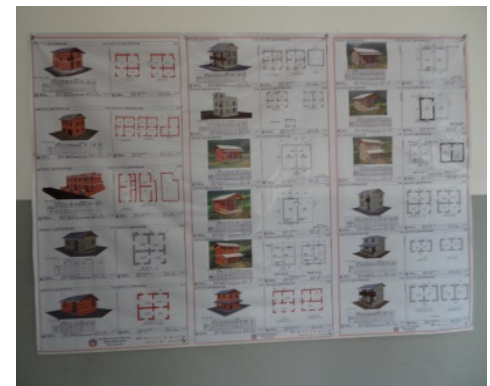
ネパール政府DUDBCが当初提示した17タイプの耐震モデル住宅(人防センター荒木主任研究員(当時)調査から)
