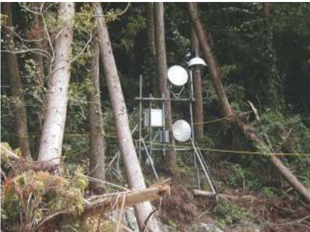
参考写真27 災害後に設置された土石流監視カメラ【d】
