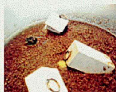
地震の揺れでバランスが崩れて重たい土が沈み、水が噴き出しています。
