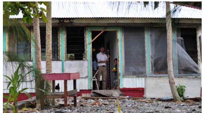
写真1 Fagamaloでの遡上高測量の様子 (家屋内の床上浸水した痕跡)
